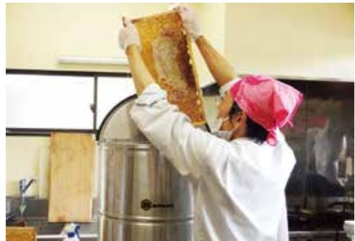
3 電動の遠心分離機に投入します。
