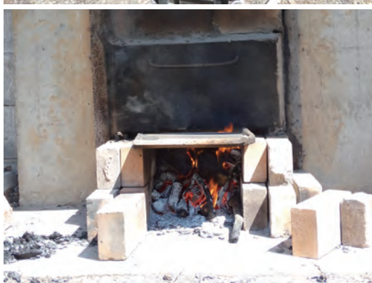
板とレンガを差し込み焚き口を狭めてみた
